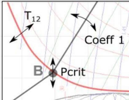
$$P_{line1} : coeff1 * (T_{gc} - T_{12}) + P_{critic}$$
